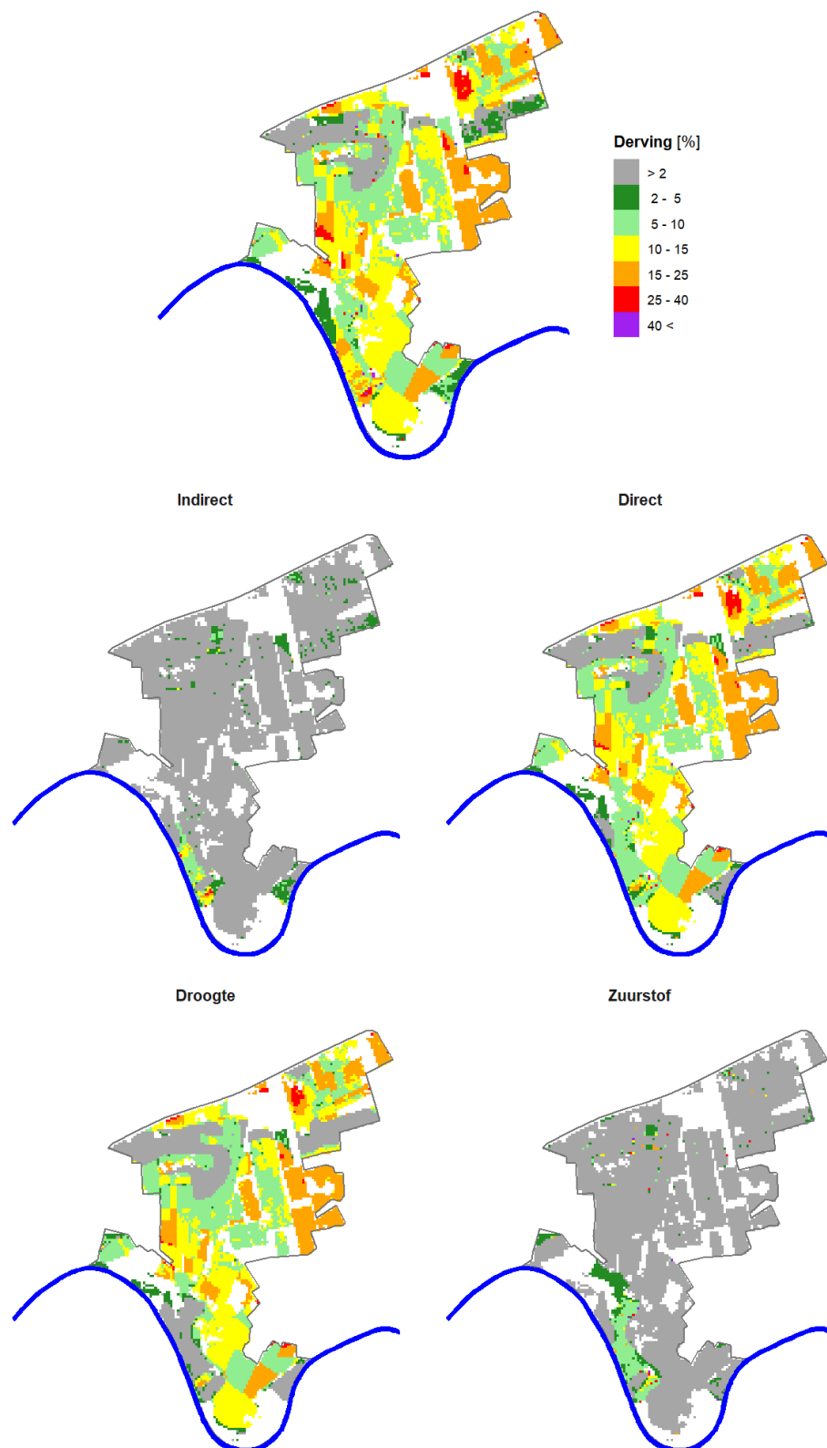
Figuur 2: Langjarig gemiddelde gewasrespons onder de huidige hydrologische condities, waarbij de totale opbrengstderving (boven) is uitgesplitst in indirecte effecten en directe effecten (midden), en de directe effecten verder zijn uitgesplitst in droogte- en zuurstofstress (onder)
